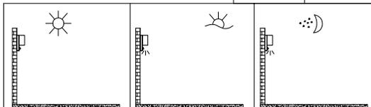
3. Имейте в виду, что всегда при смене режима при включении ВКЛ/ВЫКЛ более 6 секунд датчик движения всегда будет входить в режим разогрева длительностью до 1 минуты.
