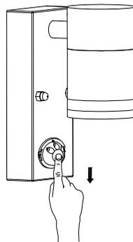
Таким образом ваш светильник будет готов к работе в автоматическом режиме, который лучше использовать в пространствах без доступа солнечного света (включение срабатывает в зависимости от времени суток)
